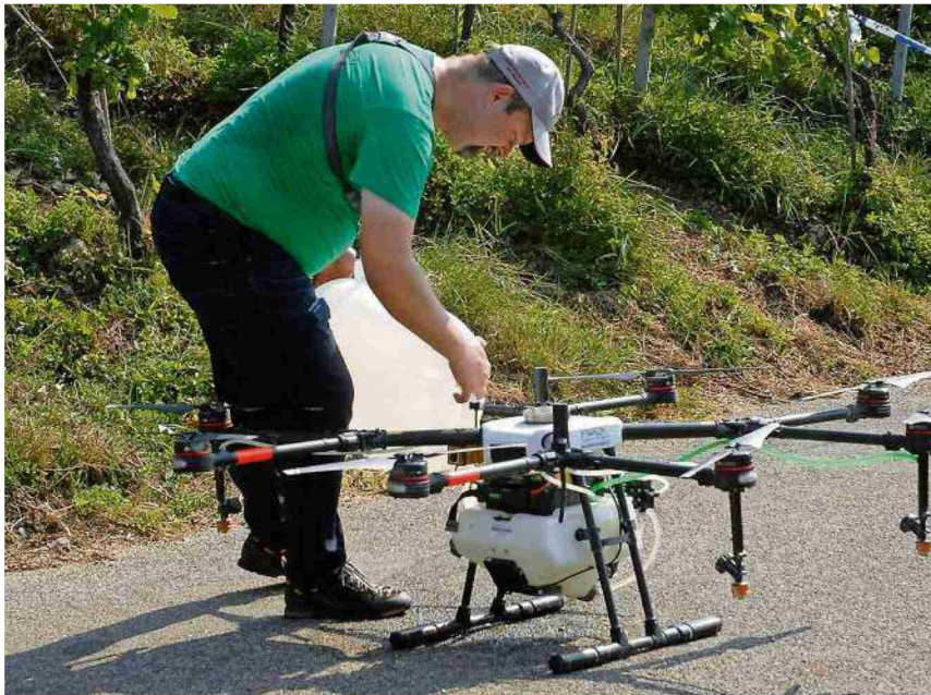
Nachschub für den Flieger. Der Zehn-Liter-Tank muss häufig nachgefüllt werden, die Akkus des Fluggeräts ebenso. Fotos Christian Horisberger
