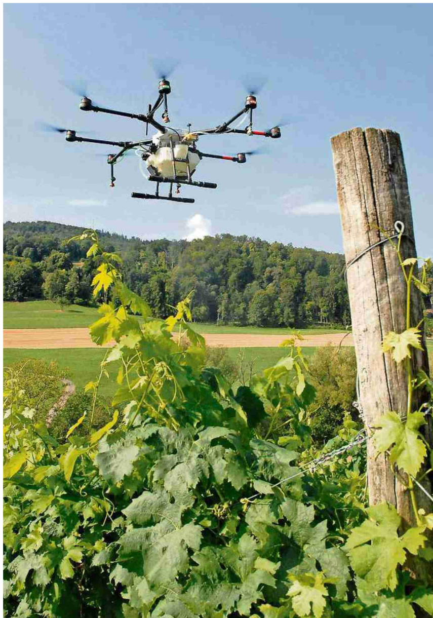
Eine Hektare pro Stunde. Die Drohne arbeitet nach der Programmierung des Einsatzbereichs präzise, kann aber nur die Laubwand besprühen.
