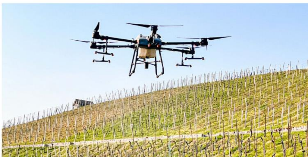
Der Verein «Wy-Erläbnis» hat die 50000 Franken teure Sprühdrohne angeschafft. Sie kann bis zu 40 Kilogramm Nutzlast tragen.
